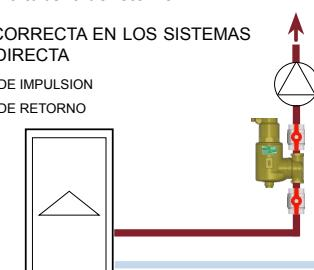
Поворотный деаэратор может быть установлен на любой участок трубопровода – горизонтальный или вертикальный, так как часть с резьбовым соединением может вращаться на 360° вокруг собственной оси.
