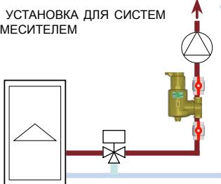
В нижней части корпуса деаэратора предусмотрено резьбовое соединение 1/2". При необходимости, может быть установлен дренажный кран арт. 3447
